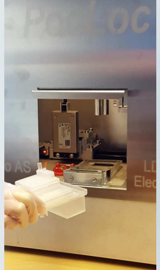
Poc LOC instrumentet med kassetten som inneholder alle komponenter nødvendig for NASBA analyse
