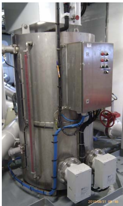
Bilde 1 og 2: Skimmer (v) og forbrenningsovn for materiale fra skimmeren (h).
