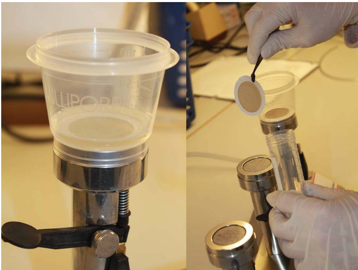
Figur 4. Filtrering av prøvemateriale før dyrking. Det ble benyttet 0,45 \mu\text{m} porestørrelse og vakumsug.
